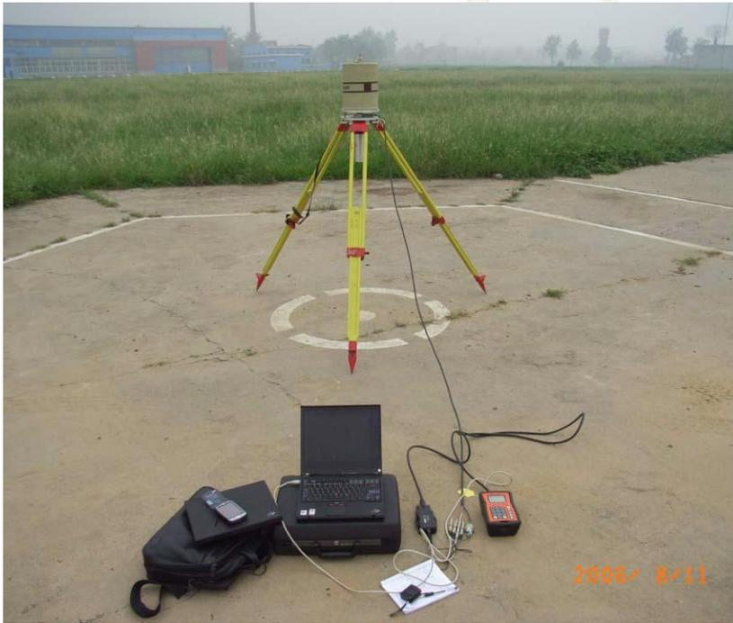
In Situ HPGe Gamma Spectrometer
